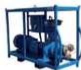
열교환기 및 펌프
