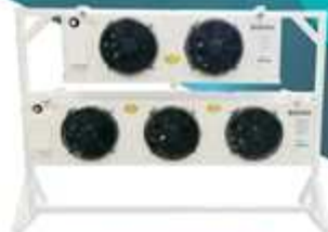
유니트쿨러 SY30 TYPE - 컴팩트 설계로 저장고 내 공간 극대화 - 3/8" Inner grooved 동관 적용, 전열효과 증대 - EBM Fan Motor 적용
